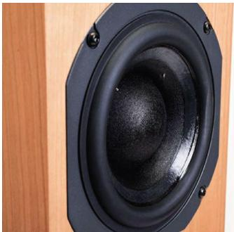
1976 entwarf ATC einen mittlerweile legendären Mitteltöner mit einer 75-mm-Gewebekalotte. Genau diese Membran dient dem 150-mm-Konustöner in der SCM19A nun als Staubschutz.
