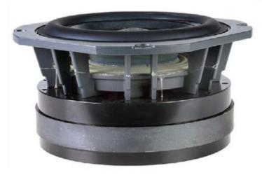
Ein Prachtexemplar von einem Lautsprecher-Chassis! Ganze 9 kg bringt allein das Antriebssystem auf die Waage. Es arbeitet nach ATCs Super-Linear-Prinzip mit kurzer Spule und langem Magnetspalt.
